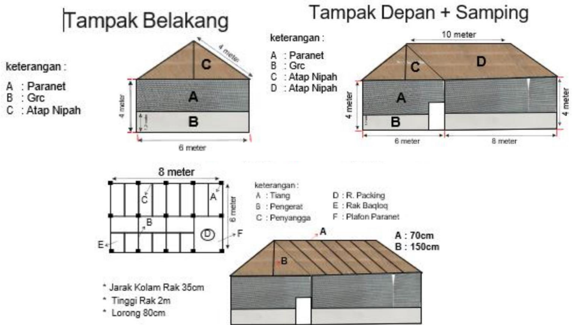
Gambar 4. Rencana Pembangunan Kumbung Jamur Tiram
