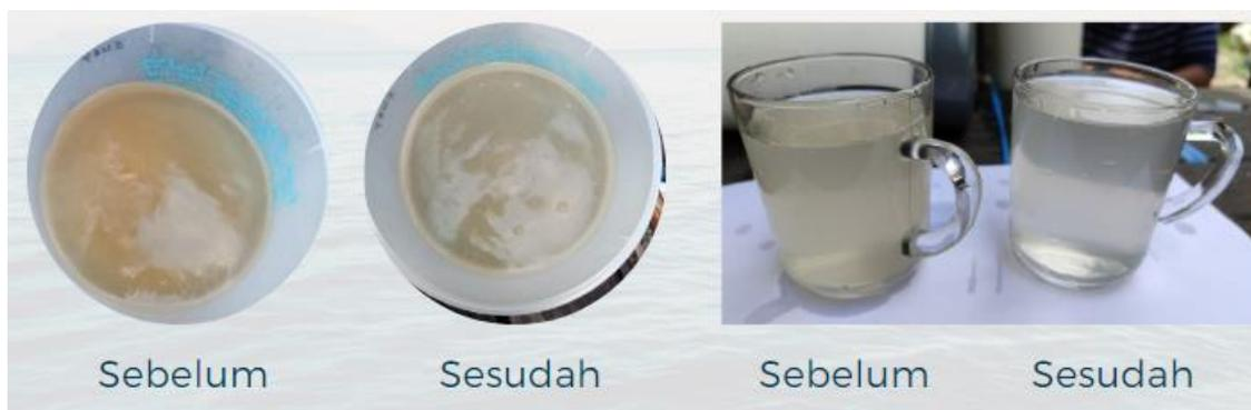
**Gambar 10. Perbandingan Air Sungai Sebelum dan Sesudah Dilakukan Filterasi Air**
