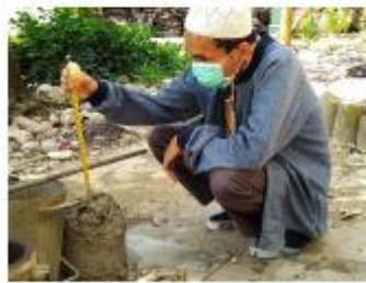
Gambar 4.8 Pengujian slump test beton segar
