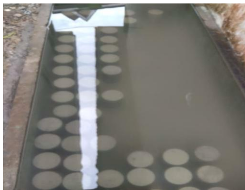
Gambar 4.9 Perawatan benda uji
