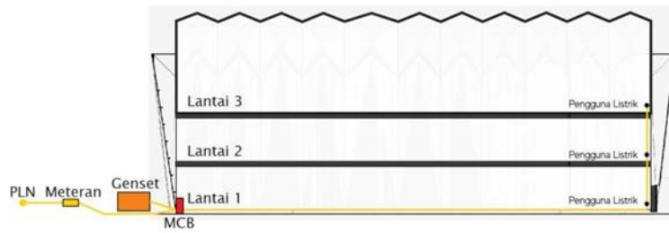
Gambar 20. Konsep Instalasi Listrik (Sumber : Hasil Konsep)
